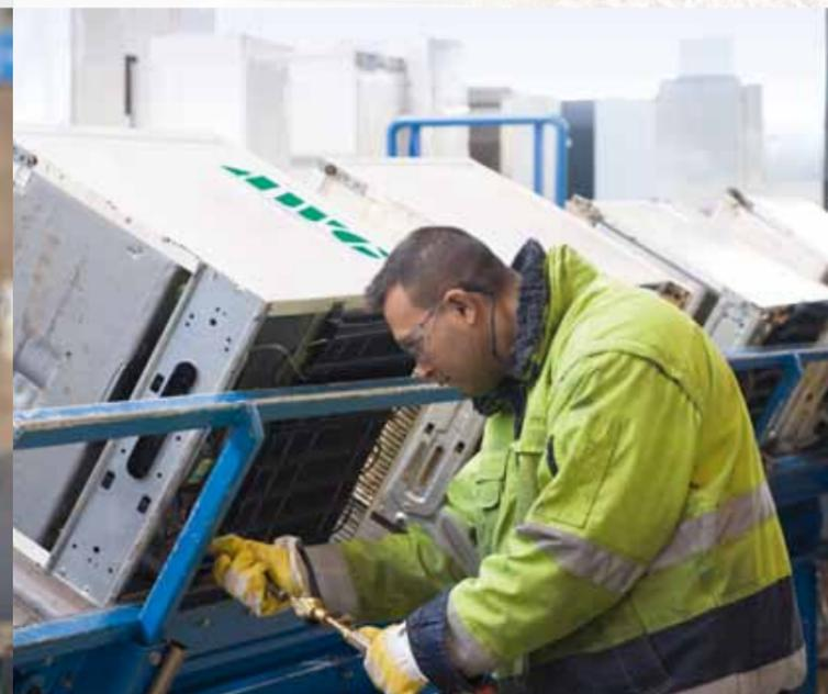
Kühlschrank auf dem Transportband – FCKW wird abgesaugt.
